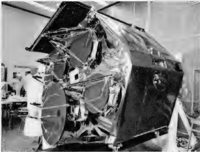
Der Orbit Test Satellit OTS, ein Nachrichtenversuchssatellit aus dem Programm der europäischen Raumfahrtorganisation Esa, auf dem Wärmeprüfstand der Erno in Bremen
