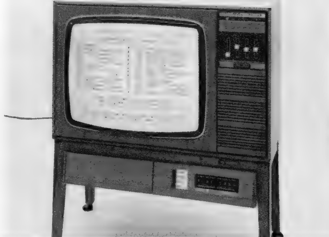
Ein von der G. E. C., England, versuchsweise für den „Teletext“-Empfang hergerichteter 20-Zoll-Farbempfänger. Das Zusatz-Modul befindet sich unterhalb des eigentlichen Gerätes
