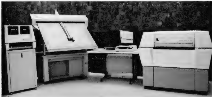
Bild 1. CAD-System der Computervision Corp. (1973); von links nach rechts: Rechner mit Speichermedien, Plotback-Digitizer, Sichtgerät mit Eingabegriffel und Fernschreiber, Fotoplotter
