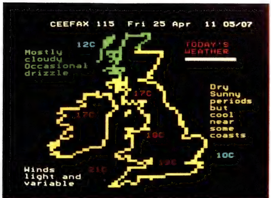
Seite 115 der hier noch Ceefax genannten Bildschirmzeitung als Beispiel für eine Wetterkarte der Britischen Inseln. Die Landkartenumrisse lassen erkennen, daß Grafik lediglich aus waagerechten und senkrechten Strichen bestehen kann
