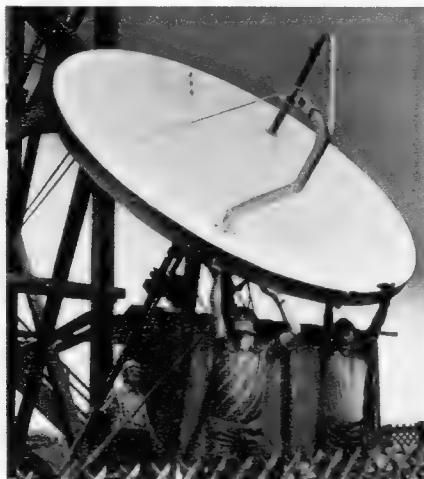
Funkverbindungen mit Satelliten ermöglicht diese Parabolantenne von 3 m Durchmesser. Die ganze Station kann in wenigen Stunden betriebsbereit aufgebaut werden
