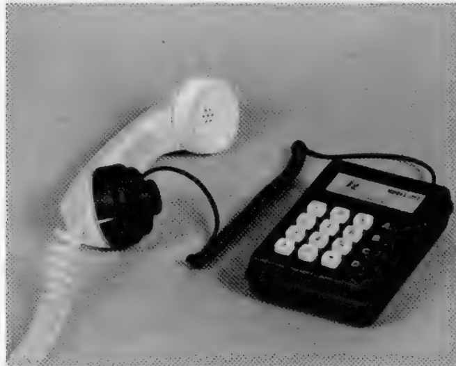
Bild 2. Dateneingabe über jedes beliebige Telefon ermöglicht diese taschenrechnerähnliche Tastatur über einen Ton-Code (Modell 722 der amerikanischen Firma interface technology, inc.)
