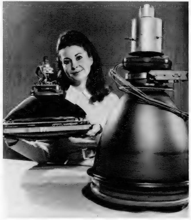
Der erste Domestik-Satellit von RCA für die Versorgung der USA vom Typ Satcom. Drei davon können die gesamte USA abdecken. Jeder Satellit trägt 24 Transponder
