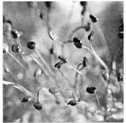
ZUM TITELBILD: Wie verführte Frühlingsblumen hat der Fotograf diese Roederstein-Heißeiter (NTC) für den Temperaturbereich -20^{\circ}\text{C} bis +70^{\circ}\text{C} aufgenommen. Zur Temperaturkompensation von Widerständen mit positivem TK werden solche Heißeiter in Reihe zu dem Widerstand geschaltet. Für die Temperaturkompensation von Halbleiterbauelementen mit negativem TK wird der Heißeiter entweder in einer Widerstandsbrücke oder auch in einer Potentiometerschaltung verwendet. Mit Meßheißleitern lassen sich Temperaturmessungen vornehmen. (Aufnahme: Roederstein)
